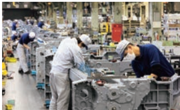
本社工場での新型エアジェットルームの組立の様子
