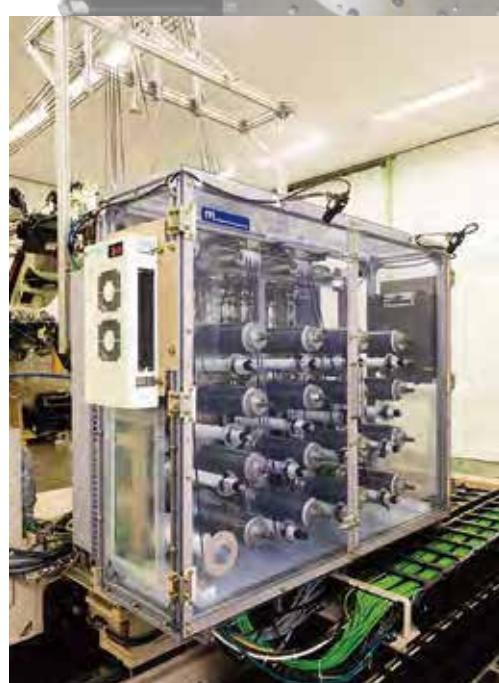
材料は熱硬化性のスリットテープで、クリールには16本(標準)のトウを搭載し、繊維機械で培われた張力制御技術により最適な状態で材料を送り出します。スリットトウは津田駒のプリプレグスリッターで製造が可能です。
