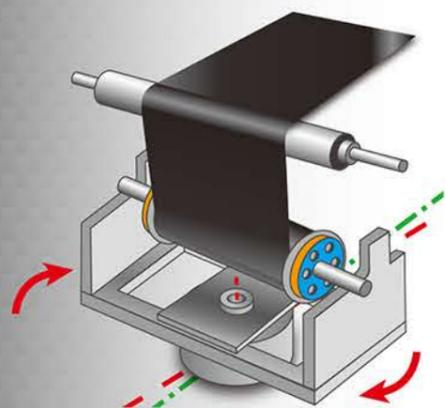
繊維機械で培った低張力巻取技術をベースとした最適な張力制御により、プリプレグに無用なストレスがかかりません。母材ロールの左右テンションのバラつき補正機構（特許取得済）を搭載し、シートの弛みや蛇行を防ぎます。
