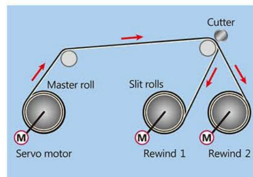
装置を構成するロール本数は最少で、送出から巻取までは片面接触です。シートの逆屈折も無いため、離型紙の剥離は起こらず、異物の混入も最小限に抑えます。
