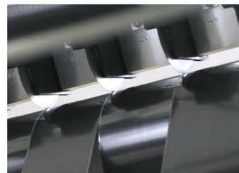
毛羽や粉塵の発生が少ないスコア式カッターを採用しています。シエアカッターのような刃間の位置調整が不要でメンテナンスも容易です。またスリット幅精度±0.1mmを実現しました。
