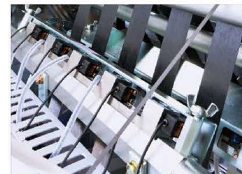
センサーでスリット状態を常時モニタリングし、異常時は機械を停止することも可能です。
